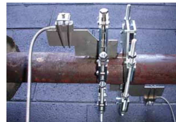
De almindelige transducere monteres på de specielle ledeplader, som med deres store areal er gode til at lede varme væk til omgivelserne, men stadig kan lede lydølger fra transducerne til røret og tilbage igen.
