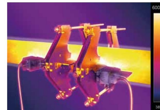
Med de almindelige transducere kan der måles på olie op til 400° C, og med højtemperatur transducere kan der håndteres smeltet salt op til 600° C.
