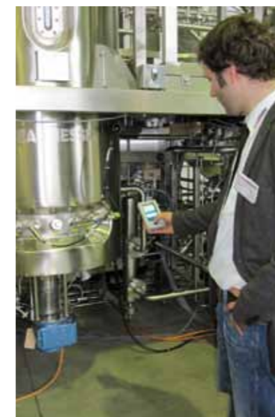
Med en håndterminal er det altid muligt at komme i kontakt med en ARC sensor.
