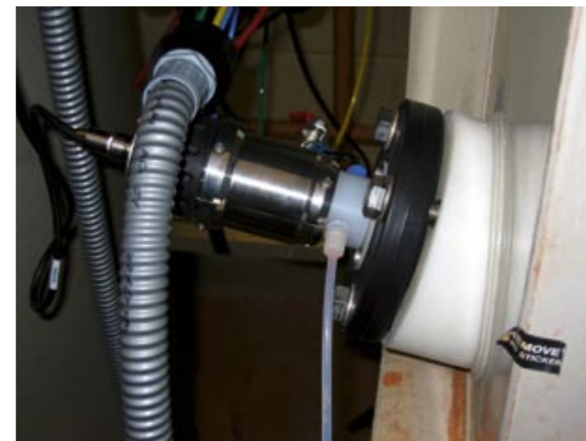
Montage i siden af tanken i en 15° vinkel med special flange produceret af Exner.
