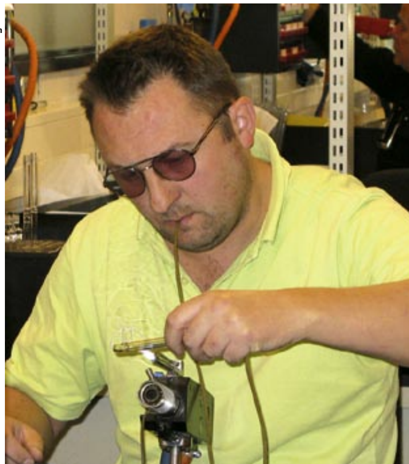
Glaspuster i dyb koncentration under produktion af pH elektrode.
