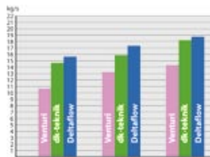
Målinger med hhv. den eksisterende venturi, dk-tekniks pitotrør og Deltaflow fra Insatech.
