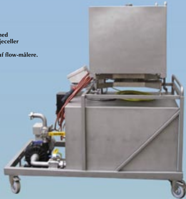
Kalibreringsvogn med tre forskellige størrelser flowmålere til at dække et større område. Vognen er også udstyret med automatiske ventiler til styring af målerstørrelse.
