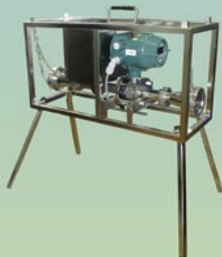
Her ses en magnetisk flowmåler som er koblet op til en datalogger med GSM sender. På den måde kan udstyret placeres ude i "marken" og data kan aflæses via PC eller endda mobil telefon f.eks. via SMS.
