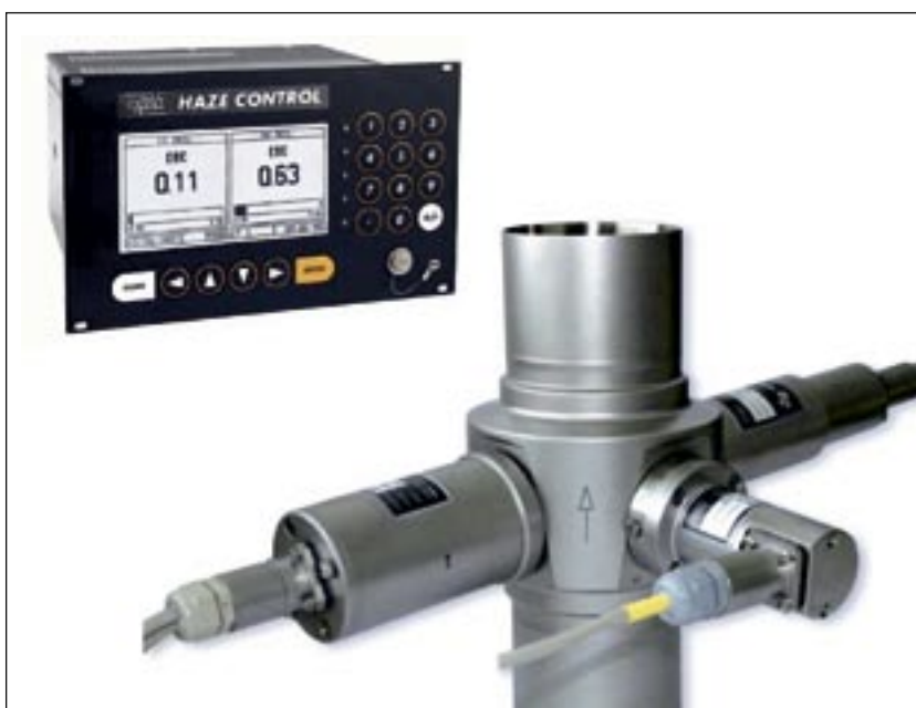
Figur C. Optek Hazecontrol til vandkvalitet samt uklarhedsmåling på øl. 0-100 NTU/FTU samt 0-25 EBC med 0,3% gentagelsesnøjagtighed.
