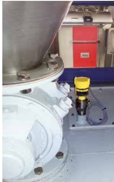
VEGAFLEX82 måler niveauet i de 3 meter høje siloer med høj nøjagtighed.
